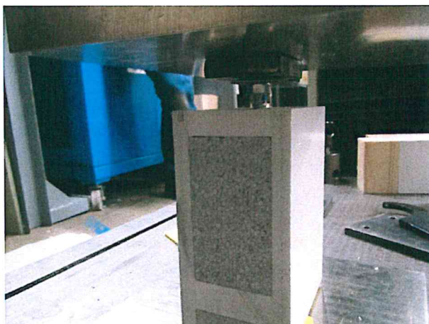
Bild A.2.2: Linkes Bild, Aufsicht, SDP, die Justierschraube vom Befestigungssystem blaugelb Protect ist direkt in das SDP eingeschraubt. Hier Probekörper Nr. 64. Rechtes Bild, Versuchsbeginn, Probekörper Nr. 65 wird in dem Versuchstand ausgerichtet. Die Druckkraft wird über eine Druckplatte eingeleitet
