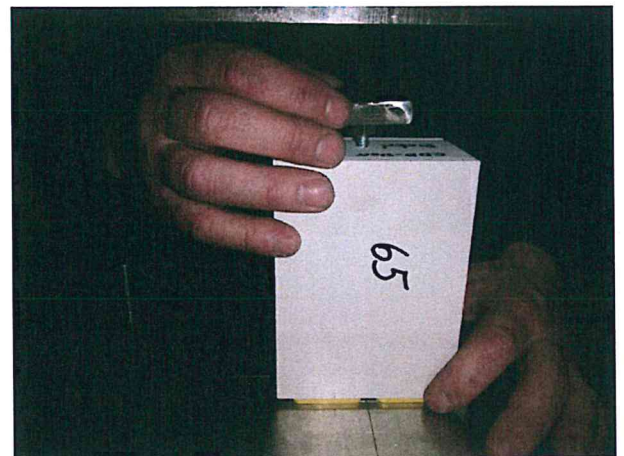
Bild A.2.2: Linkes Bild, Aufsicht, SDP, die Justierschraube vom Befestigungssystem blaugelb Protect ist direkt in das SDP eingeschraubt. Hier Probekörper Nr. 64. Rechtes Bild, Versuchsbeginn, Probekörper Nr. 65 wird in dem Versuchstand ausgerichtet. Die Druckkraft wird über eine Druckplatte eingeleitet
