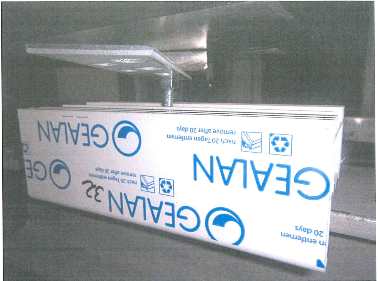
Bild A.2.1: Untersicht an Probe Nr. 32, Versuchsbeginn, das Kunststoffprofil Gealan 9000 ist in den Versuchsstand eingebaut. Die Druckkraft der Prüfmaschine wird über eine Druckplatte auf die Justierschraube des blaugelb Protect Befestigungssystem eingeleitet
