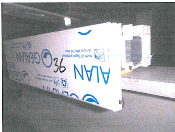
Bild A.2.2: Linkes Bild, Probe Nr. 36, Versuchsbeginn, Kunststoffprofil Gealan 9000. Rechtes Bild, Versuchsbeginn, Probekörper Nr. 41, das Kunststoffprofil Salamander hat eine Stahlarmierung von t = 2,0 \text{ mm}
