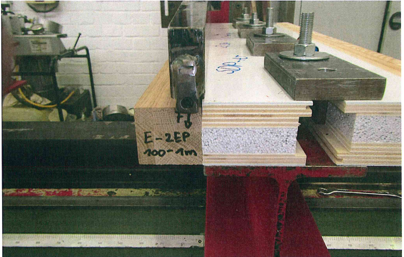
Bild A.4.1: Seitenansicht zum Versuch Nr. 51. Der Probekörper Nr. 51 ist eingebaut (Stahlträger IPB 160 in rot). Das SDP hat eine Breite von l = 100 mm. An zwei Haltepunkten, e = 80 cm, ist je eine Schraube zur Montage verschraubt
