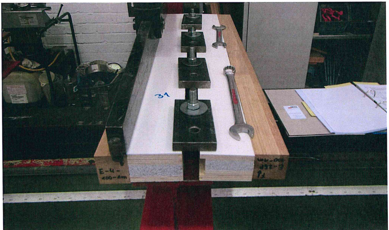
Bild A.5.2: Versuchsbeginn, Versuch Nr. 31. Zur besseren Lagerung bzw. Fixierung des Probekörpers auf dem IPB 160 Stahlträger ist ein zweiter Probekörper hinzugefügt worden
