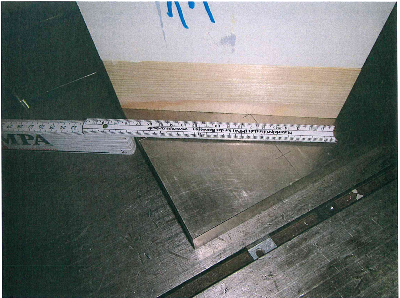
Bild A.2.1: Ansicht und Detail blaugelb Sockeldämmprofilen (PVC/EPS), hier ProbekörperNr. 11, l_{\text{Profil}} = 197 \text{ mm}
