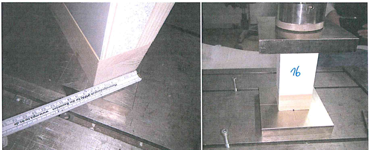
Bild A.2.2: Linkes Bild, Breite Probekörper, hier Nr. 11. Rechtes Bild, Versuchsbeginn, Probekörper Nr. 16 ist in den Versuchsstand eingebaut. Die Abmessungen bei den Versuchen Nr. 15 und Nr. 16 waren geringer, es wurden Längen l von l_{15} = 93 \text{ mm} und l_{16} = 95 \text{ mm} geprüft
