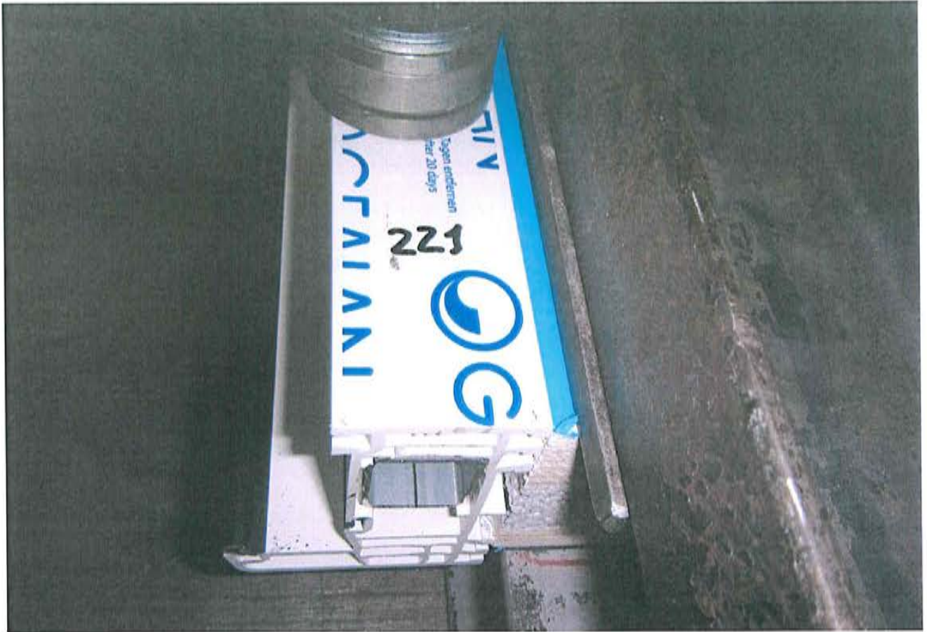
Bild A.9.1: Seitenansicht zum Versuch Nr. 221. Der Probekörper ist eingebaut. Das SDP hat eine Breite bzw. Tiefe von l = 100 mm. Das SDP mit einer Länge l = 200 mm ist nur mit einer Schraube mit dem Kunststoffprofil Gealan 9000 ( l = 200 mm) verschraubt
