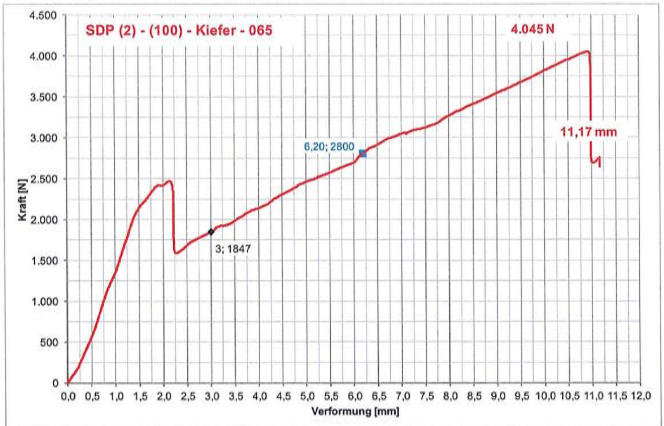
Dia A.12.1: Kraft-Verformungsdiagramm zum Versuch Nr. 065
