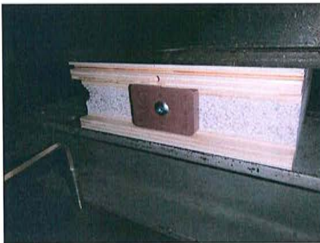
Bild A.9.2: Linkes Bild, Seitenansicht zum Versuch Nr. 221. Der Probekörper ist eingebaut. Das SDP hat eine Breite bzw. Tiefe von l = 100 mm und lagert auf einem T-Profil auf. Das SDP ist nur mit einer Schraube verschraubt. Rechtes Bild, Detail zur Vertiefung im SDP, erforderlich für die Befestigung nur mit einer Schraube
