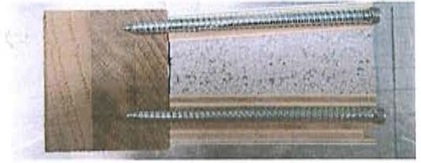
Bild A.3.1: Ansicht und Detail Holzprofil. Linkes Bild, Verschraubung des SDP mit dem Holzprofil über eine Schraube je Befestigungspunkt. Rechtes Bild Verschraubung des SDP mit dem Holzprofil über zwei Schrauben je Befestigungspunkt
