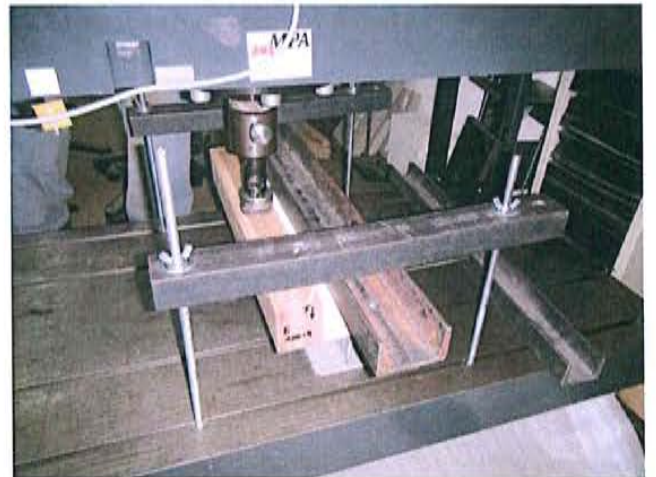
Bild A.7.2: Linkes Bild, Seitenansicht zum Versuch Nr. 111. Der Probekörper ist eingebaut. Das SDP hat eine Breite bzw. Tiefe von l = 100 mm und lagert auf einem T-Profil auf. Rechtes Bild, das SDP ist im Versuchstand eingebaut. Mit vier Abspannungen wird der Versuchskörper in der Prüfmaschine gesichert
