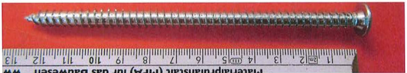
Bild A.3.4: blaugelb Rahmenfixschrauben FK-T30, \varnothing 7,5 | = 122 mm
