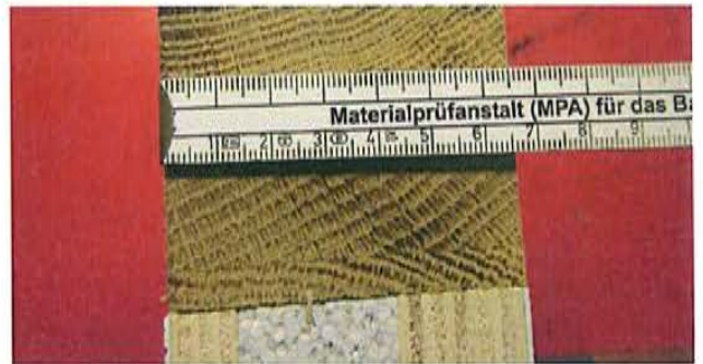
Bild A.3.2: Ansicht und Detail Holzprofil. Linkes Bild, Profilbreite b = 60 mm. Rechtes Bild, Profilhöhe h = 68 mm
