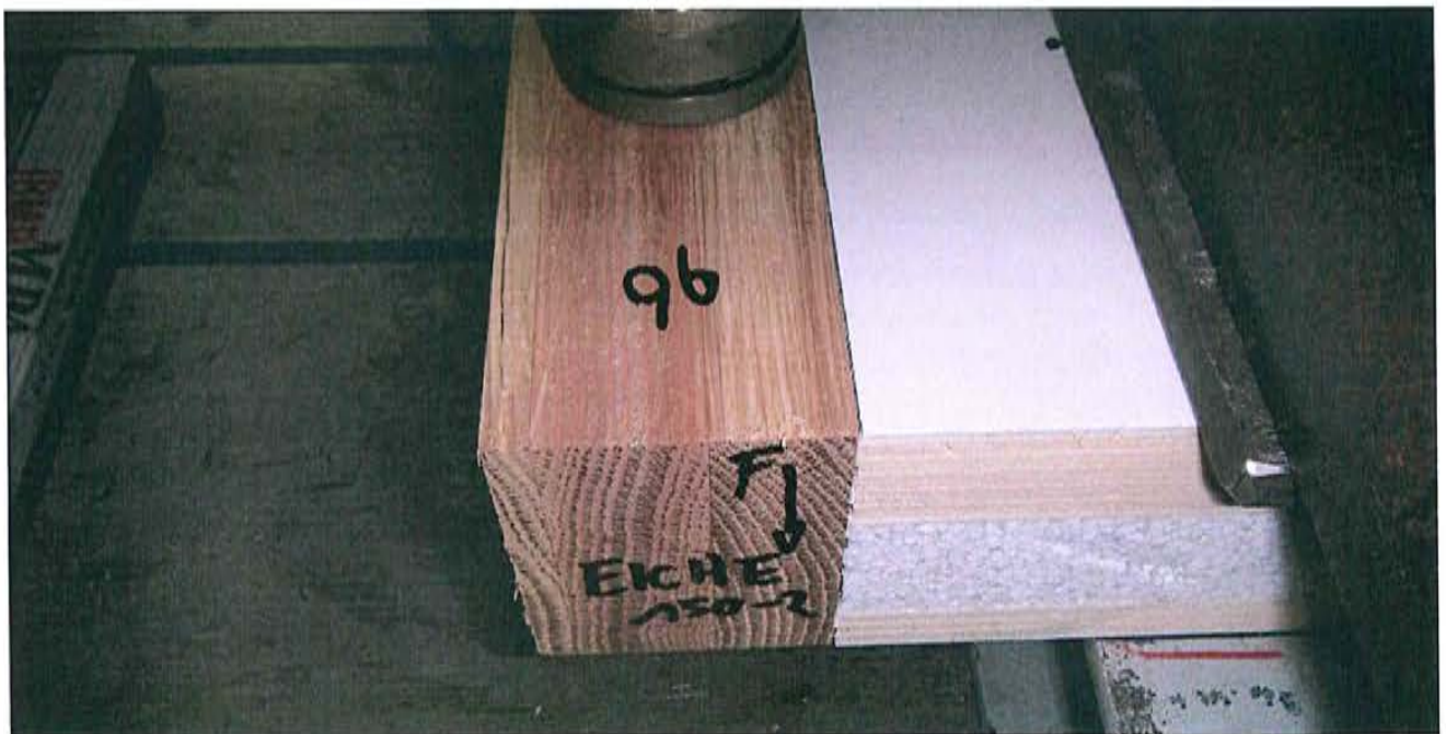
Bild A.6.2: Seitenansicht zum Versuch Nr. 96. Der Probekörper Nr. 96 ist eingebaut. Das SDP hat eine Breite von l = 150 mm. Das SDP ist mit zwei Schrauben im Holzprofil (Eiche) verschraubt
