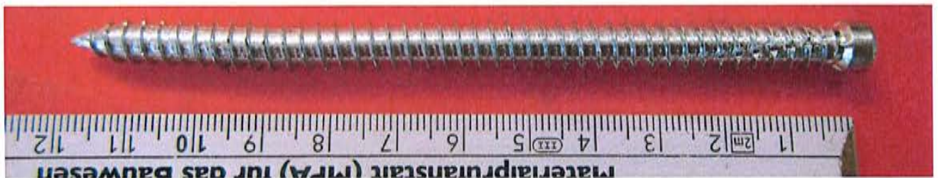
Bild A.3.3: blaugelb Rahmenfixschrauben ZK-T30, \varnothing 7,5 | = 122 mm
