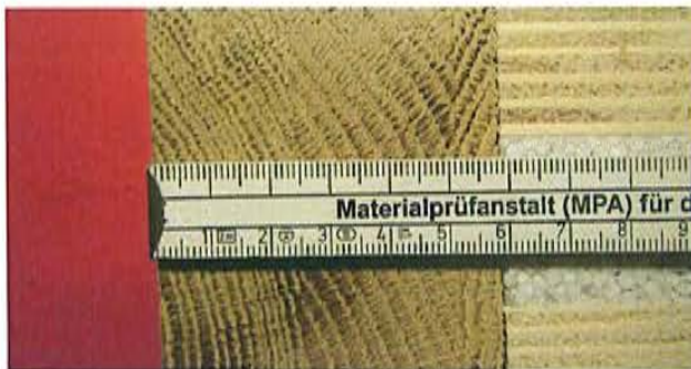
Bild A.3.2: Ansicht und Detail Holzprofil. Linkes Bild, Profilbreite b = 60 mm. Rechtes Bild, Profilhöhe h = 68 mm
