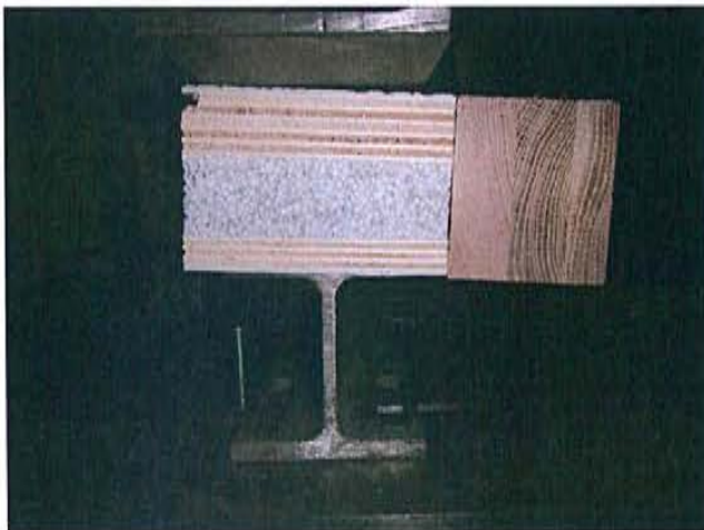
Bild A.7.2: Linkes Bild, Seitenansicht zum Versuch Nr. 111. Der Probekörper ist eingebaut. Das SDP hat eine Breite bzw. Tiefe von l = 100 mm und lagert auf einem T-Profil auf. Rechtes Bild, das SDP ist im Versuchstand eingebaut. Mit vier Abspannungen wird der Versuchskörper in der Prüfmaschine gesichert
