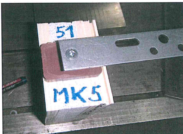
Bild A.2.2: Linkes Bild, Aufsicht, SDP und Befestigungssystem blaugelb Protect ist über die Verklotzung eingeschraubt. Hier Probekörper Nr. 51. Rechtes Bild, Versuchsbeginn, Probekörper Nr. 51 ist in den Versuchsstand eingebaut. Die Druckkraft wird über eine Druckplatte eingeleitet
