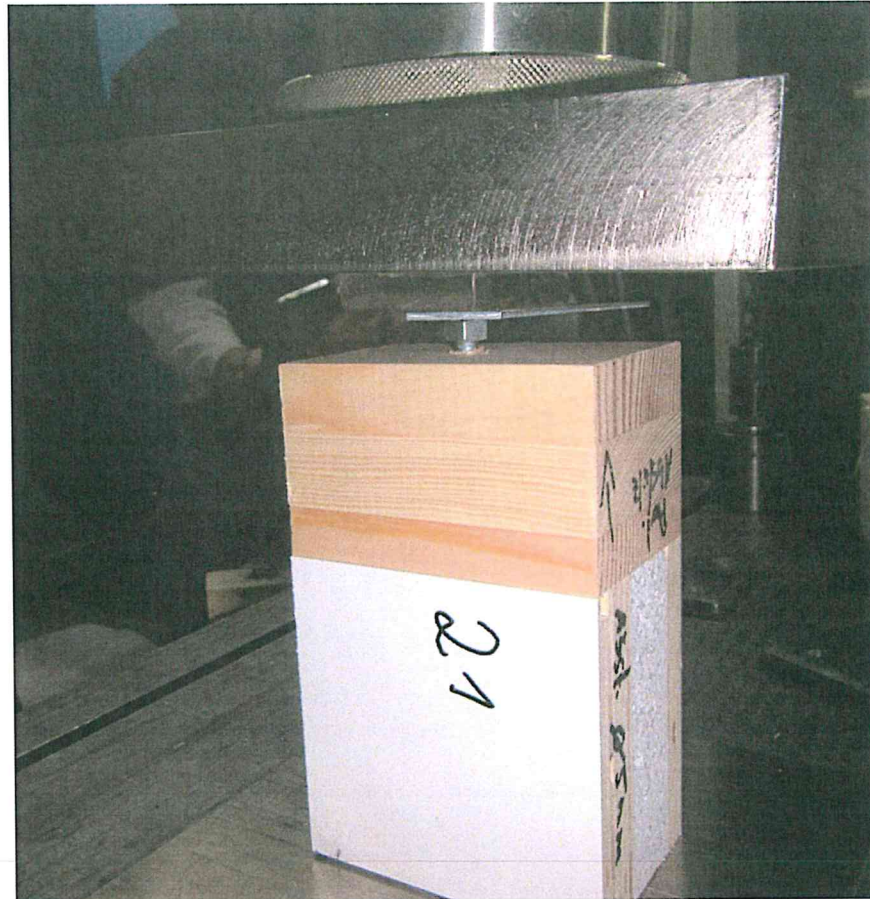
Bild A.3.1: Ansicht und Detail vom System blaugelb Sockeldämmprofilen (PVC/EPS), Befestigungssystem blaugelb Protect und Holzrahmenprofil, hier Probekörper Nr. 21. Die Druckkraft wird über das Holzrahmenprofil in das SDP eingeleitet
