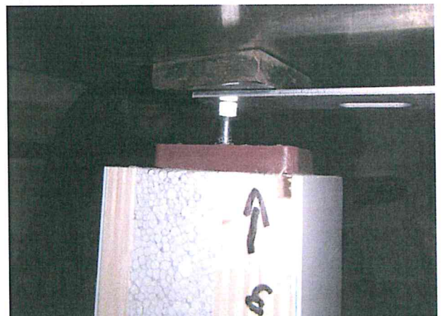
Bild A.2.2: Linkes Bild, Aufsicht, SDP und Befestigungssystem blaugelb Protect ist über die Verklotzung eingeschraubt. Hier Probekörper Nr. 51. Rechtes Bild, Versuchsbeginn, Probekörper Nr. 51 ist in den Versuchsstand eingebaut. Die Druckkraft wird über eine Druckplatte eingeleitet
